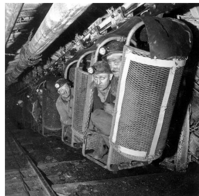
Transport de personnel au fond par télésiège à la fosse 3 de Lens à Liévin, 24 octobre 1966 © Centre Historique Minier (prêt ANMT)
